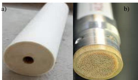
**Figura 1:** Membrana: a) Flatsheet membranes empilhada; b) Hollow fibre membranes dentro de um módulo (para purificação de gás). [3]
